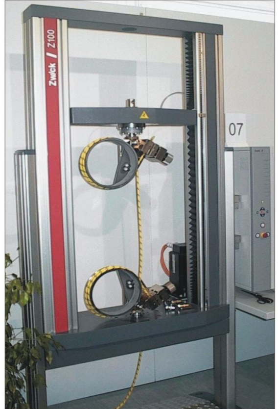
Sarmal (roller) çenelerle halat çekme testi
