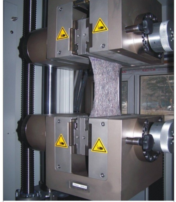
Paralel sıkmalı hidrolik çenelerle geotekstil çekme testi
